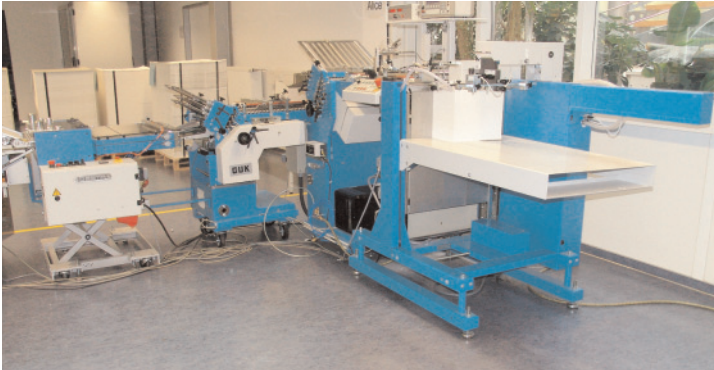
Ergebnis eines gemeinsamen Projekts: Die GUK-Falzmaschine für spezielle, kleingefaltete und verschleißbare Packungsbeilagen für die Pharmaindustrie.
