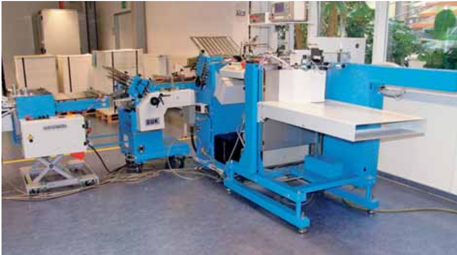
Ergebnis eines gemeinsamen Projekts: Die GUK-Falzmaschine für spezielle, kleingefaltete und verschleißbare Packungsbeilagen für die Pharmaindustrie.
