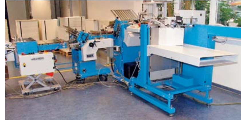
Die GUK-Falzmaschine für spezielle kleingefaltete und verschließbare Packungsbeilagen für die Pharmaindustrie.
