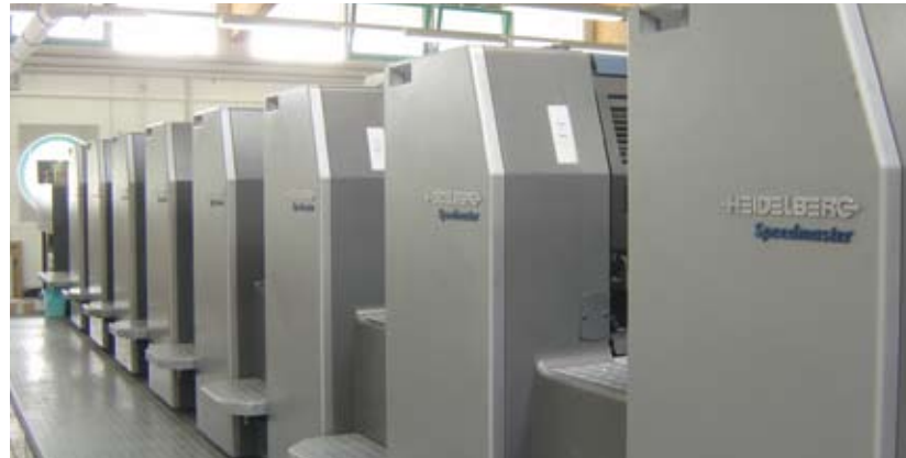
8-Farben Heidelberg Speedmaster Druckmaschine.
